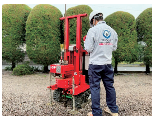
※自社開発の地盤調査機IGP(左)と 「地盤カルテ®」(中) 「地盤安心マップ®PRO」(右)
