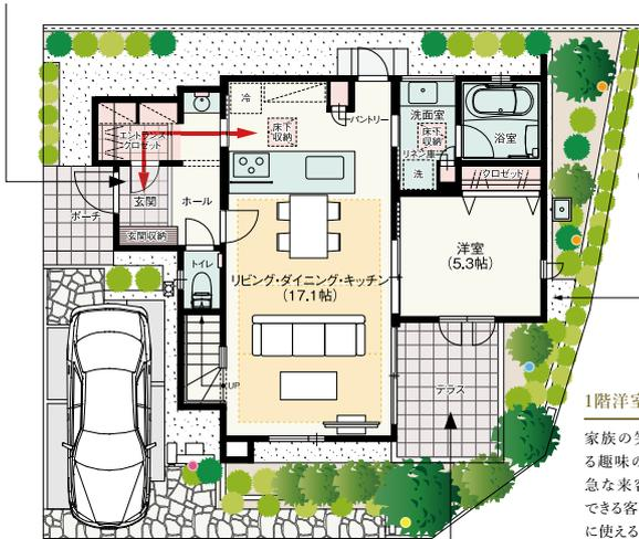
敷地配置図兼1階平面図
